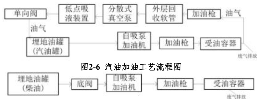
图2-7 柴油加油工艺流程图
