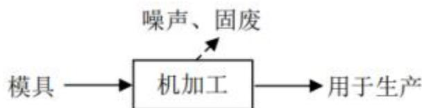
图 2-6 模具加工工艺及产污流程图
